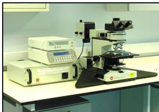
شکل ۶: نمایی از دستگاه لینکام جهت مطالعه میانبارهای سیال
